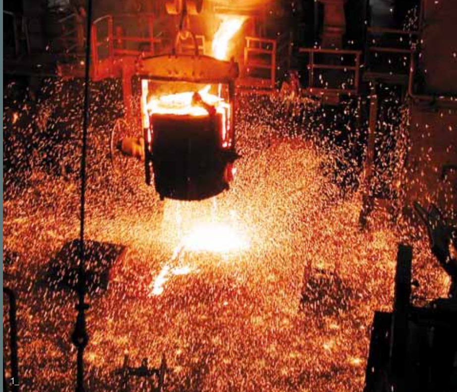
1_ Flydende metal bliver hældt ud af Elektro lysbueovn.
